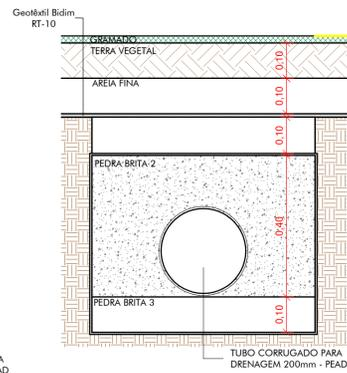
4 Detalhe Tubo de 200mm
