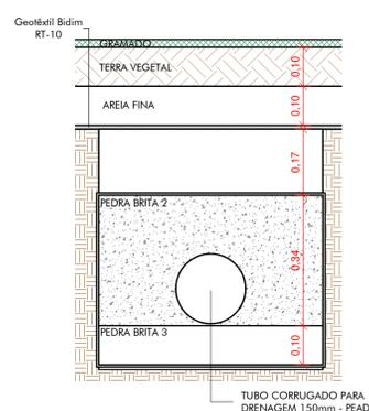
3 Detalhe Tubo de 150mm
